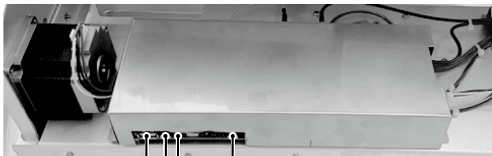
Port USB Bouton de mise à jour LED rouge et vert Bouton de réinitialisation (RESET)
