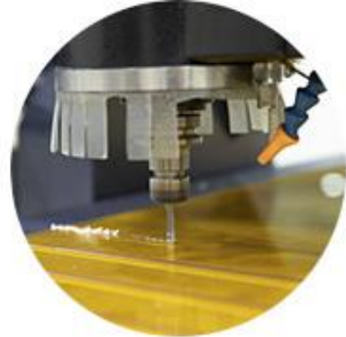
포토마스크 케이스 제조 시 CNC(Computer Numerical Control) 가공
