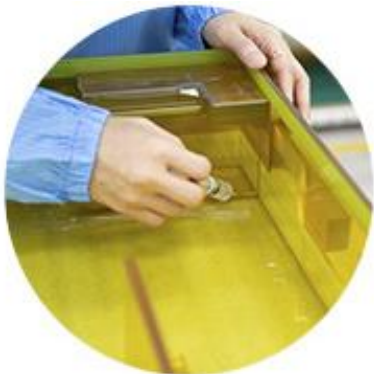
포토마스크 케이스의 CNC 가공 이후 내부 및 외부 조립
